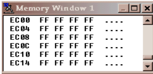
Fig. 1 - Ventana de Memoria en el sistema FLASH_POD , donde se observa el Bloque de memoria "TABLA" totalmente borrado ($FF).
