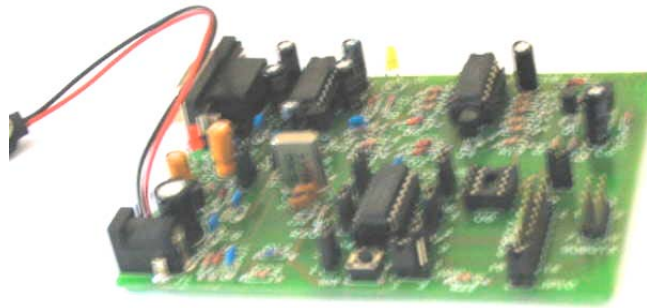
Figura 5. – Emulador en Tiempo Real “EVAL08QTY” p/ los HC908QT / QY / QB.
